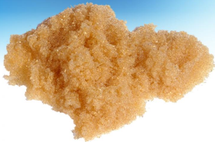
Silny kationit zmięczający wodę. Nigdy go nie widzisz, ponieważ jest w kolumnie filtracyjnej
