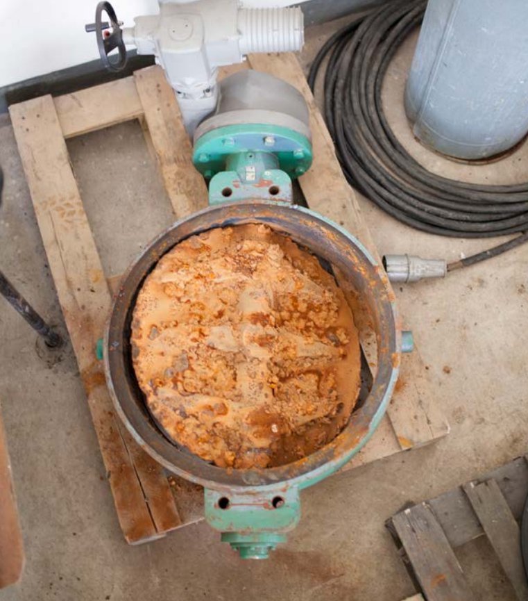
Zasuwy DN500 z napędem pneumatycznym. Odrzuwające się cząstki twardego kamienia uszkodziły okrąg dysku i spowodowały nieszczelność
